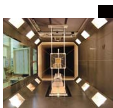
↑ 通風時の住宅を想定した風洞実験
