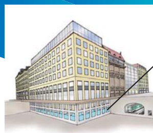
↑ 蓄熱槽を有する建物
