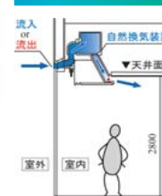
高層オフィスの自然換気口 ↑
