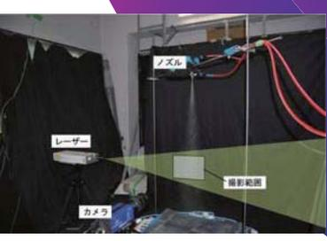
↑ PIV解析による噴霧粒子速度の測定
