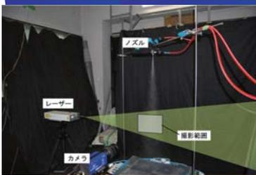
↑ PIV解析による噴霧粒子速度の測定
