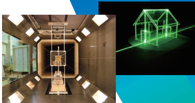
↑ 通風時の住宅を想定した風洞実験
