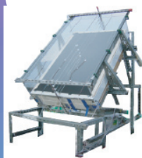
↑ 実物大模型による屋外実験 ← ソーラーチムニーによる住宅換気
