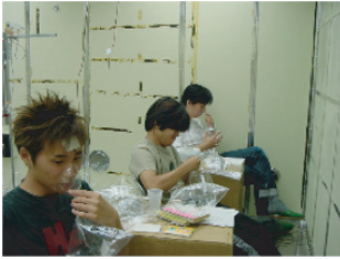
↑ 建材から発生するにおいの捕集法 ← におい袋法によるにおいの主観評価実験
