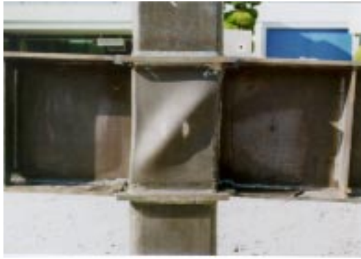
写真 1 せん断座屈の様子(試験体名: R4216-5)
