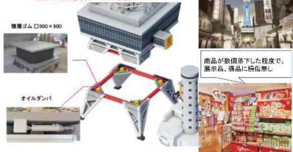
図-8 免震改修した通天閣
